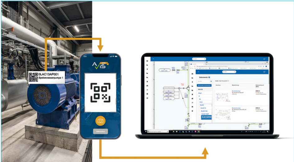
Abb. 5: Anlagenkennzeichnung nach KKS/AKZ und QR-Code mit Nutzungsmöglichkeiten
